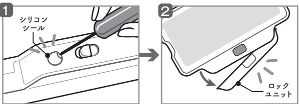
スライドボタンの間にいるシリコンシールを、先の細いもので剥がすことでロックユニットを分解できるネジが出てきます。
